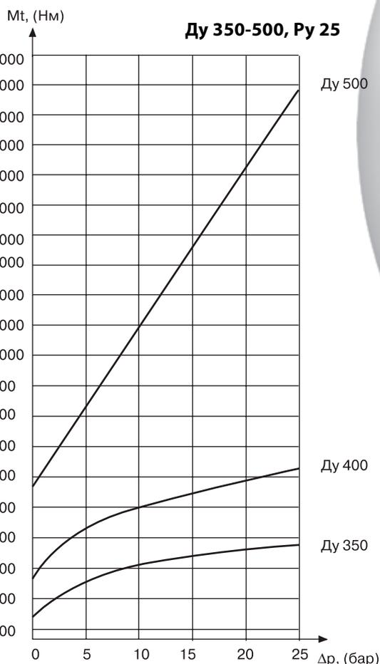
Помещенные здесь значения усилия, необходимого для закрытия крана, – это ориентировочные значения, полученные в результате измерений для новых шаровых кранов. Данная характеристика подразумевается как момент отрыва для шаровых кранов, которые закрыты и находятся в таком положении непродолжительное время.
