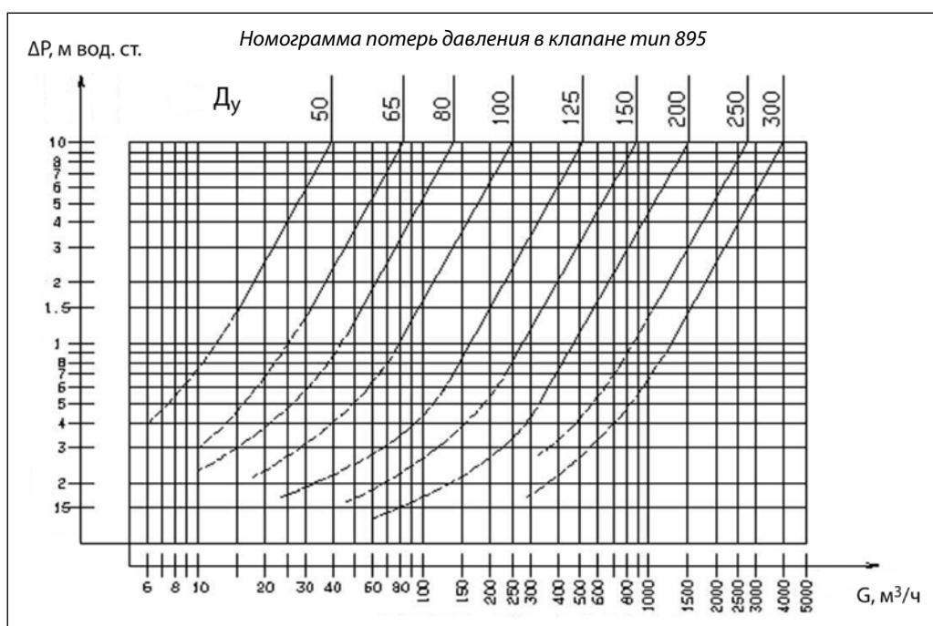
Во избежание возникновения осцилляций потока и осевых колебаний затвора следует избегать завышения диаметра трубопровода и обратного клапана, т. е. желательно, чтобы клапан не работал
