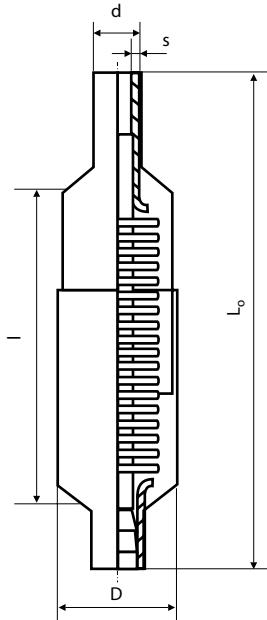
**Осьевые сильфонные компенсаторы ARF P<sub>y</sub> 10 бар с внутренней гильзой
