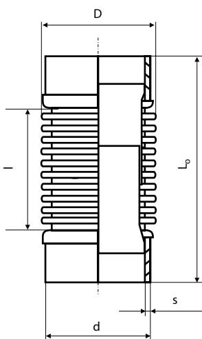
**Оевые сильфонные компенсаторы ARN P<sub>y</sub> 16 бар с внутренней гильзой
