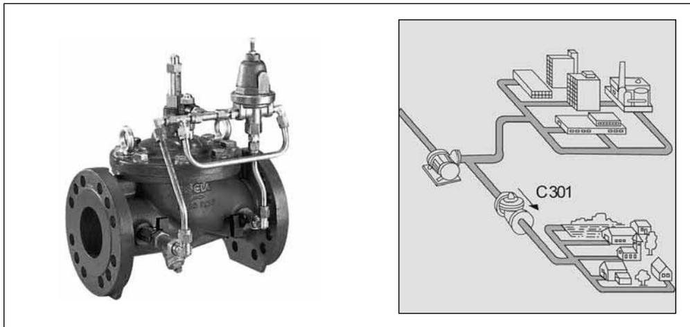
Регулирующий клапан типа С301 предназначен для регулирования и поддержания давления «до себя» на постоянной установленной величине независимо от колебаний давления и расхода.
