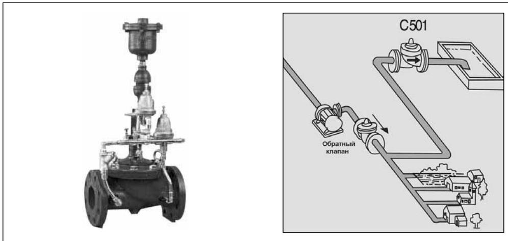
Клапан C501 защищает от неконтролируемого роста давления (гидравлического удара), возникающего в случае прекращения электроснабжения насосных агрегатов или их аварийной остановки.
