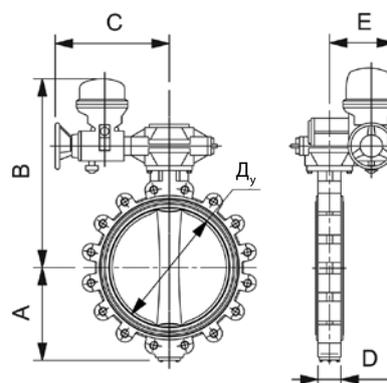
Габаритные и присоединительные размеры ENODIA с уплотнением EPDM и электроприводом AUMA (400 В, открыт/закрыт)
