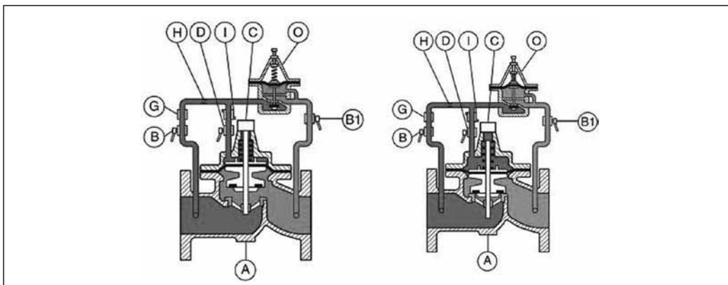
Как только уровень в емкости станет ниже заданного пилотный клапан О откроется. Верхняя камера основного клапана А частично опорожнится, клапан А откроется и емкость начнет заполняться.
