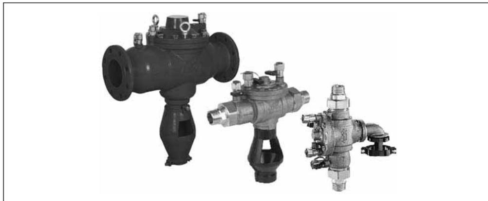
Защита сетей осуществляется автоматическим прерыванием водоснабжения абонента с последующим опорожнением клапана и удалением поступившей от абонента воды с возможными загрязнениями в дренаж. Все клапаны поставляются проверенными на работоспособность в заводских условиях. Конструкция обратных клапанов типа VA2760, VA2760CD, VA4760 позволяет проводить периодическую проверку на работоспособность без демонтажа и прекращения подачи воды абоненту.
