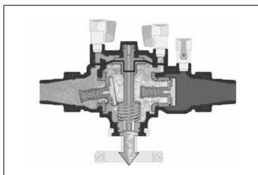
4. В случае нарушения герметичности обратного клапана со стороны сети водоснабжения:
