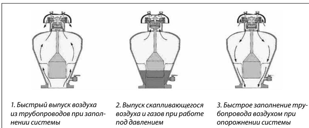
Схема установки клапана VE330 на трубопровод
