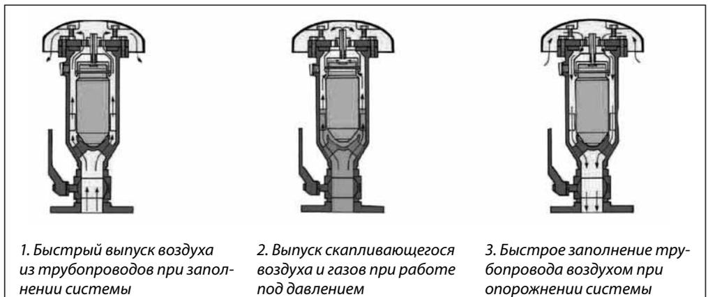
Схема установки клапана VE320 на трубопровод
