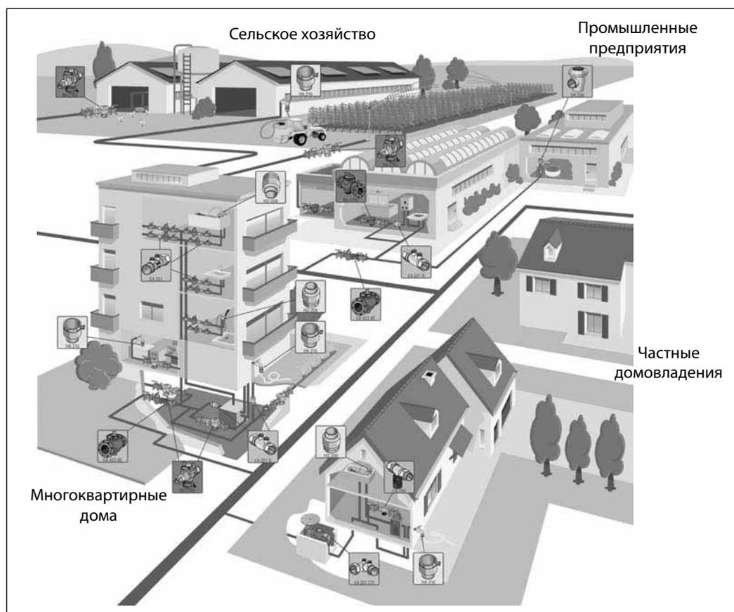
Обратные клапаны типа BA2760, BA2760CD и BA4760 применяются в качестве устройств, через которые производится подключение потребителей воды к сетям питьевого водоснабжения.
