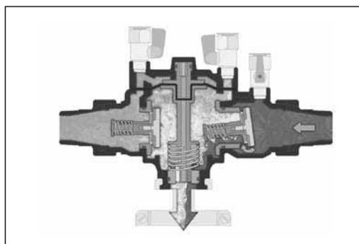
3. В случае нарушения герметичности обратного клапана со стороны абонента
